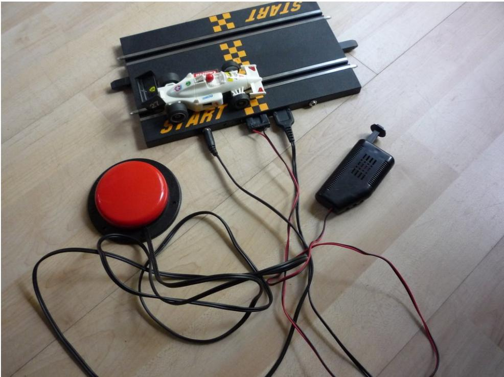
Das ist ein Teil einer CarreraBahn. Den Regler kann man mit Klebeband bei einer sinnvollen Geschwindigkeit fixieren. Die Taste schaltet dann den Strom ein und das Auto saust los.
